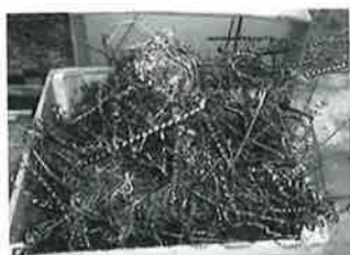
写真2 切りくずの体積を減らした例
