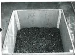
写真2 切りくずの体積を減らした例
