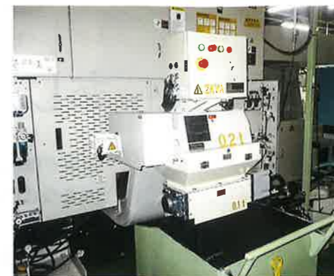
チップコンベヤーの排出口に切りくず破砕機「SSCL-Wシリーズ」を設置した例(三愛エコシステム)
